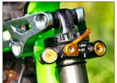
Das DBInLine-Federbein bietet maximale Setup-Optionen: Luftdruck sowie Compression und Rebound – beides in Low- und High-Speed.
