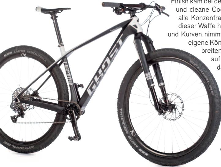
auf Oversize-Format auf und erweitern damit den Grenzbereich. Grenzwertig ist dagegen die Tretlagersteifigkeit: Bei kräftigen Bikern verwindet sich der Hinterbau so, dass die rechte Kurbel den Kettenstrebenschutz touchiert.
