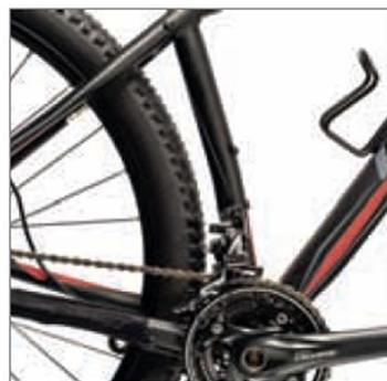
Per Knick weicht das Sitzrohr dem 29er-Laufrad aus. So wird der Hinterbau kurz und das Rad wendig.
