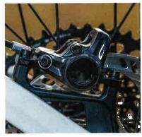
Vier Kolben vorne, zwei Kolben hinten (Bild). Magura setzt das Konzept seiner Trail-Bremsen auch an der preiswerten Thirty2 fort.
