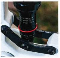
Der Dämpfer sitzt auf einer Brücke. Eine Änderung des Federwegs durch Tausch der Brücke (wie beim Vorgänger) ist nicht vorgesehen.
