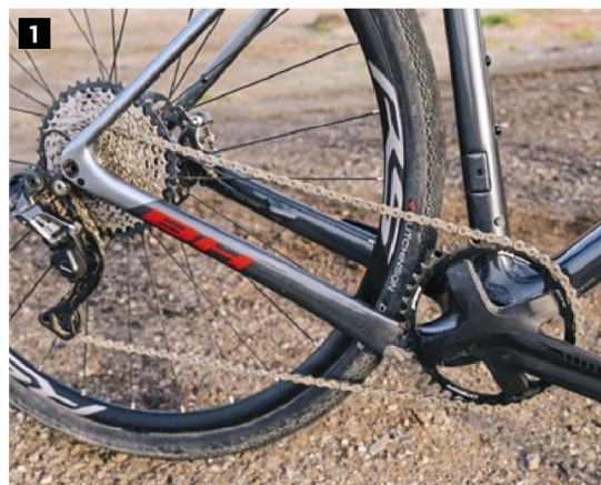
Größe: L, Preis: 3699 Euro, Gewicht: 9,4 kg, Ausstattung: Shimano GRX Di2 40x11-42, Shimano RS370, Hutchinson Override 700x38, Rahmenmaterial: Carbon, Oberrohrlänge: 571mm, Sitzrohrlänge: 520mm, Reach/Stack: 390/575,7 mm, Lenkwinkel: 72,5°, Sitzwinkel: 72,5°
